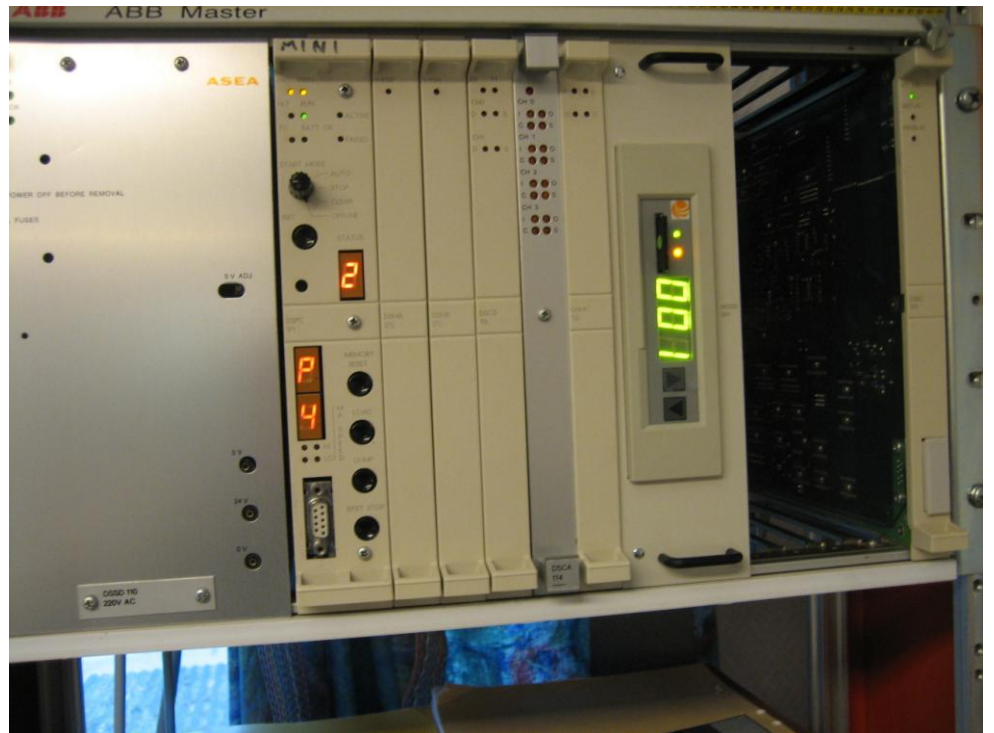
Figur 11 NDDD 001 enheten är upptagen, lysdioden Busy är Tänd.
