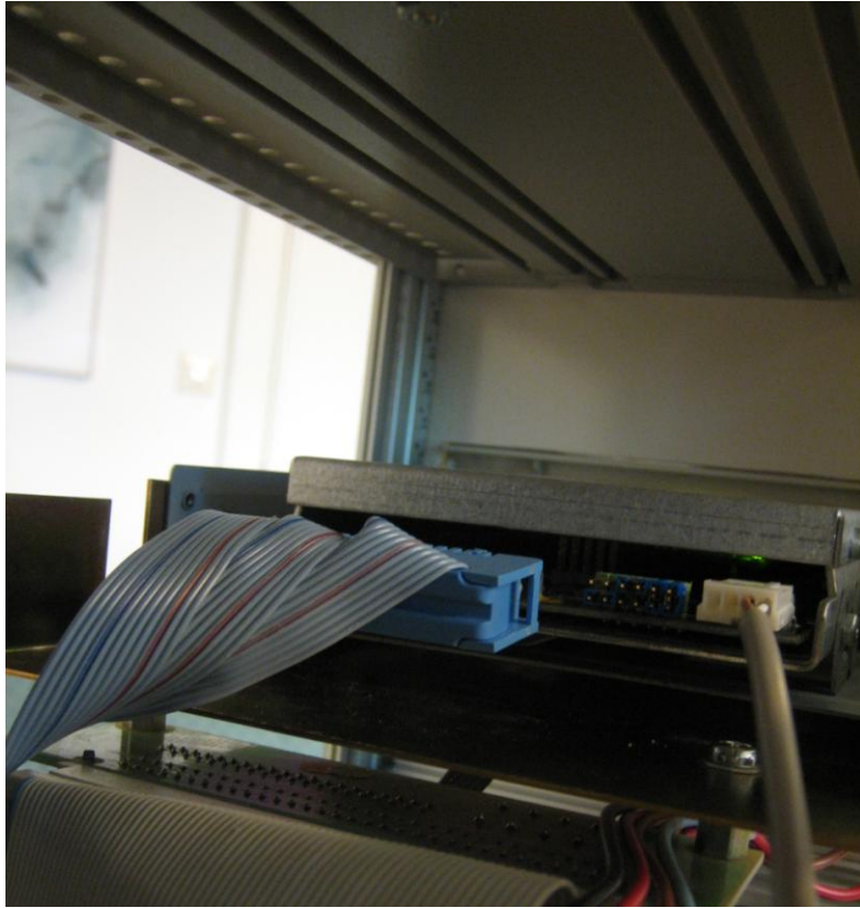
Figur 16 Anslut signalkabeln till DDR enheten.
