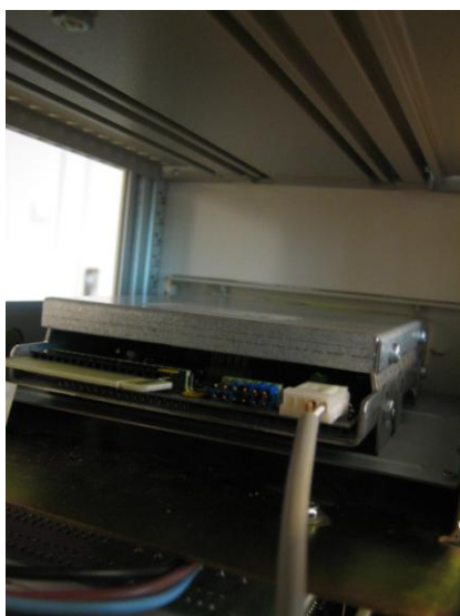
Figur 15 Anslut spänningskabeln till DDR enheten.
