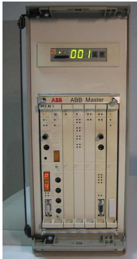
Figur 1 DDR enhet av typ NDDD 002 monterad i MasterView 830 kabinett.
