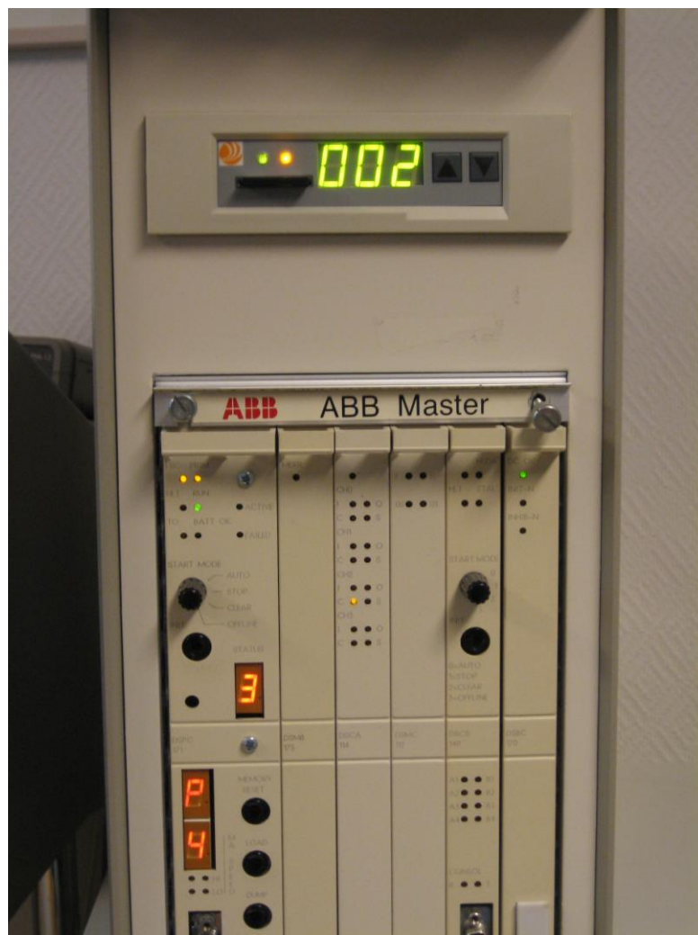
Figur 17 NDDD 002 enheten är upptagen, lysdioden Busy är Tänd.
